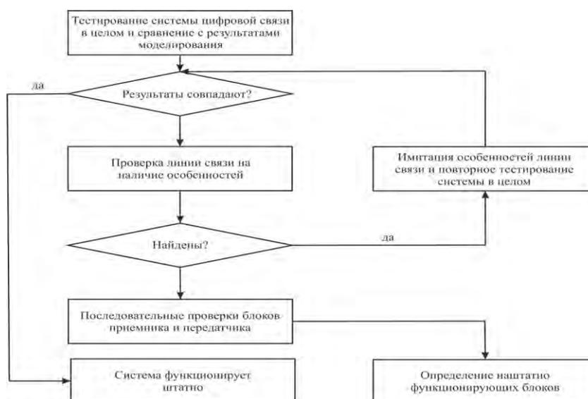
Рис. 2. Схема тестирования цифровой системы связи
