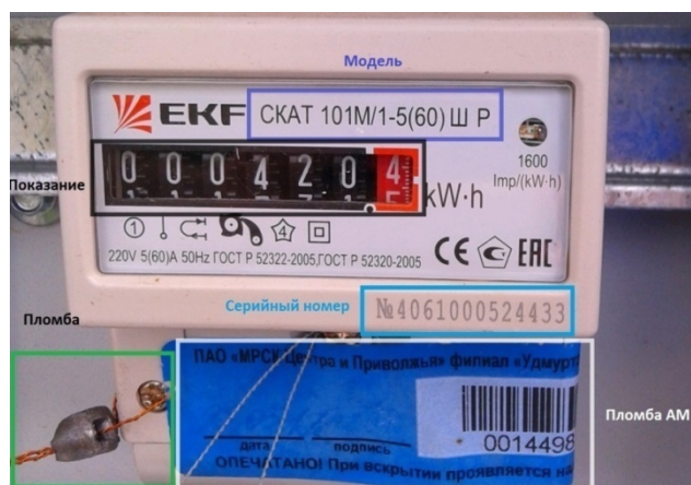
Рис. 1. Выделение объектов для распознавания (пломба, модель, показание, серийный номер, пломба, пломба АМ)
