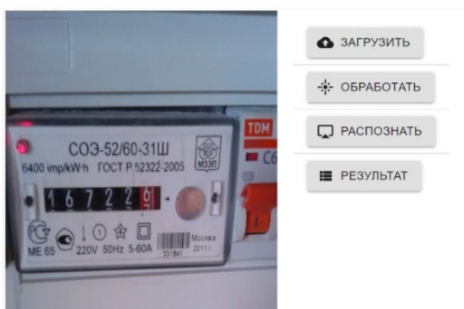
Рис. 3. а) интерфейс программы, б) обработанная часть изображения с показаниями прибора учета
