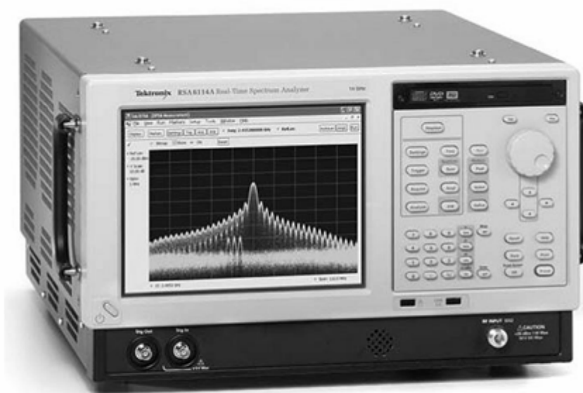
Рис. 3. Внешний вид анализатора радиочастотного спектра реального времени серии RSA6000 корпорации Tektronix
