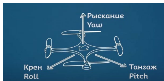
Рис.2. Три основных угловых ориентации квадрокоптера
