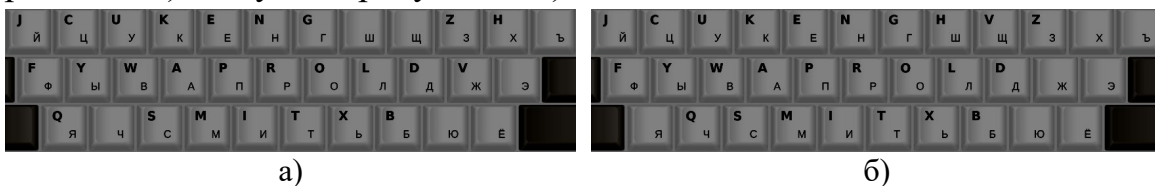
Рис. 5. Фонетическая раскладка латиницы JCUKEN: оригинальная БК Электроника (а) и компактная (б)
