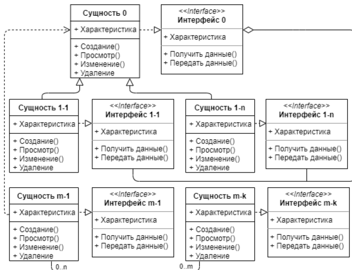
Рис. 1. Диаграмма классов UML для автоматизированной системы управления
