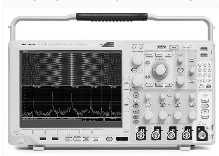
Рис.1. Внешний вид осциллографа MDO4000
