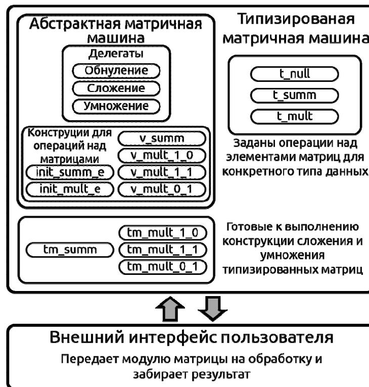
Рис. 1. Архитектура абстрактной трехмерно матричной машины
