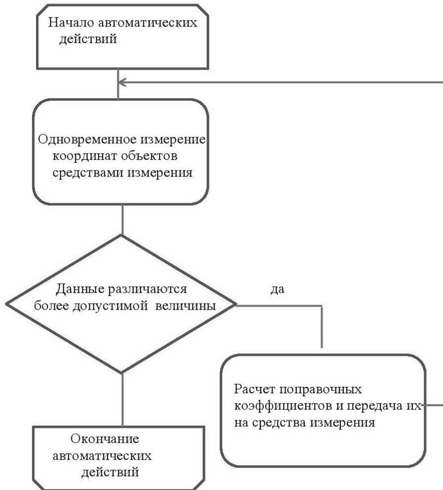
Рис. 1. Блок-схема алгоритма автоматических юстировочных работ
